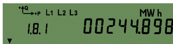
Слика 5. – Екран бројила B на коме је приказана тренутна вредност активне електричне енергије у првој тарифи са резолуцијом показивања енергије на три децимална места у мегаватчасовима.
